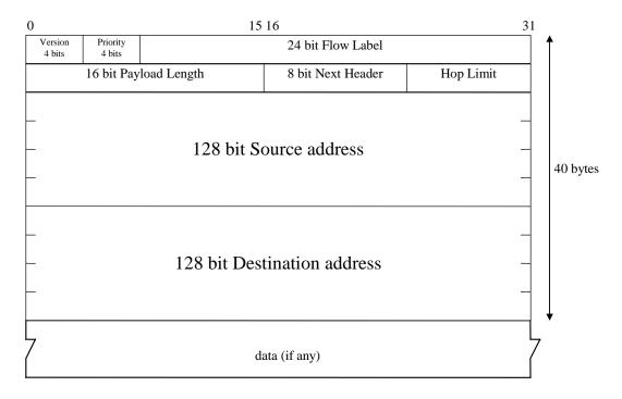
Figure 20. The IPv6 header
